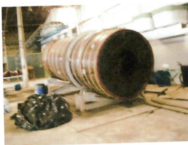
Figura 13 – Tanque de remolho
